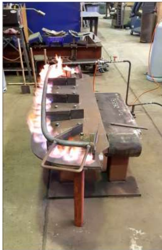
Efter värmning till rätt temperatur har den 12 mm tjocka plåtens smitts till rätt form med hjälp av handläggor. Plåten har ännu visat övermått på kanterna. Foto Jonas Forsén 13 februari 2020.
